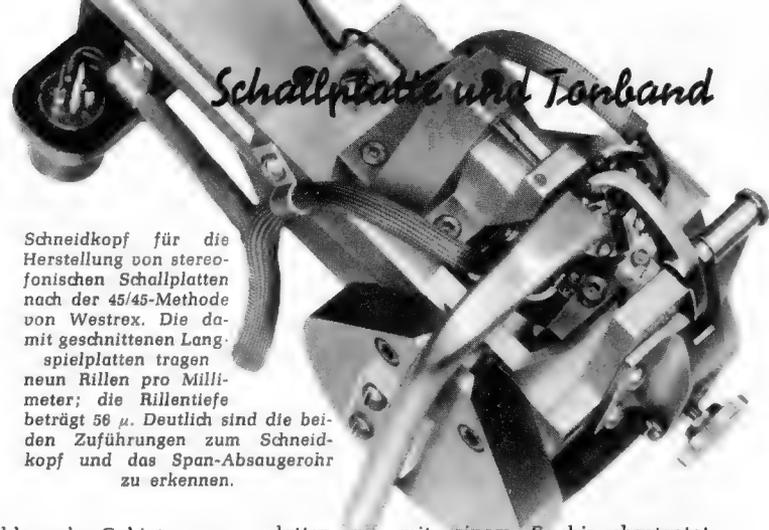
Schneidkopf für die Herstellung von stereofonischen Schallplatten nach der 45/45-Methode von Westrex. Die damit geschnittenen Langspielplatten tragen neun Rillen pro Millimeter; die Rillentiefe beträgt 50  $\mu$ . Deutlich sind die beiden Zuführungen zum Schneidkopf und das Span-Absaugerohr zu erkennen.
