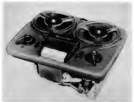
Bild 1. Das TK-5-Chassis fertig zum Einbau
