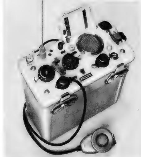
Bild 1. Tragbares Lotsen-Funksprechgerät Philips-„Portofon“ in wasserdicht und schwimmfähiger Ausführung
